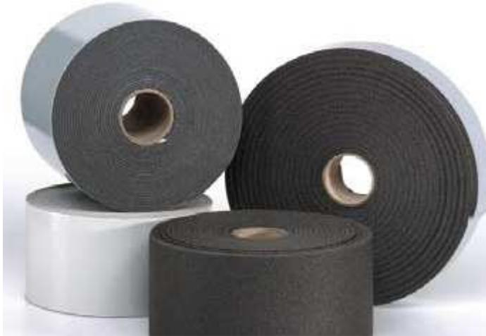
Banda de espuma de polietileno reticulado de celda cerrada autoadhesiva, que puede usarse para rematar la junta del final de la lámina de impacto en contacto con la pared u otro elemento pasante del forjado. También debe ser usada para cubrir la junta de unión entre láminas, para evitar el paso de mortero hacia el forjado.
